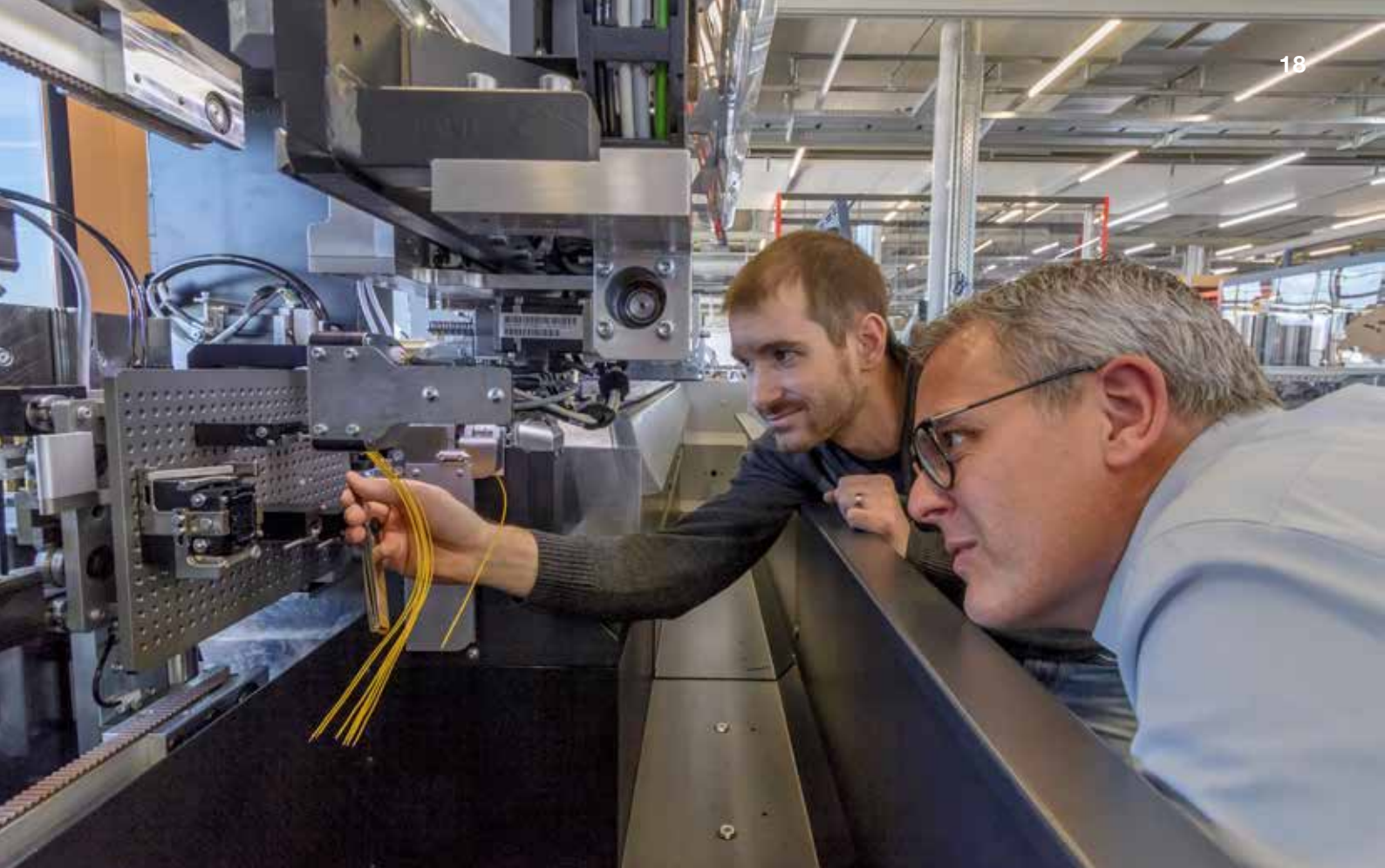
Bei praxisnahen Bestückungstests auf unseren Maschinen montieren wir die zu testenden Gehäuse auf einer individuell gefertigten Palette und bestücken diese mit dem zur Verfügung gestellten Material. Produktmanager Roland Liem (rechts im Bild) zusammen mit Application Engineer Manuel Schmidt.
